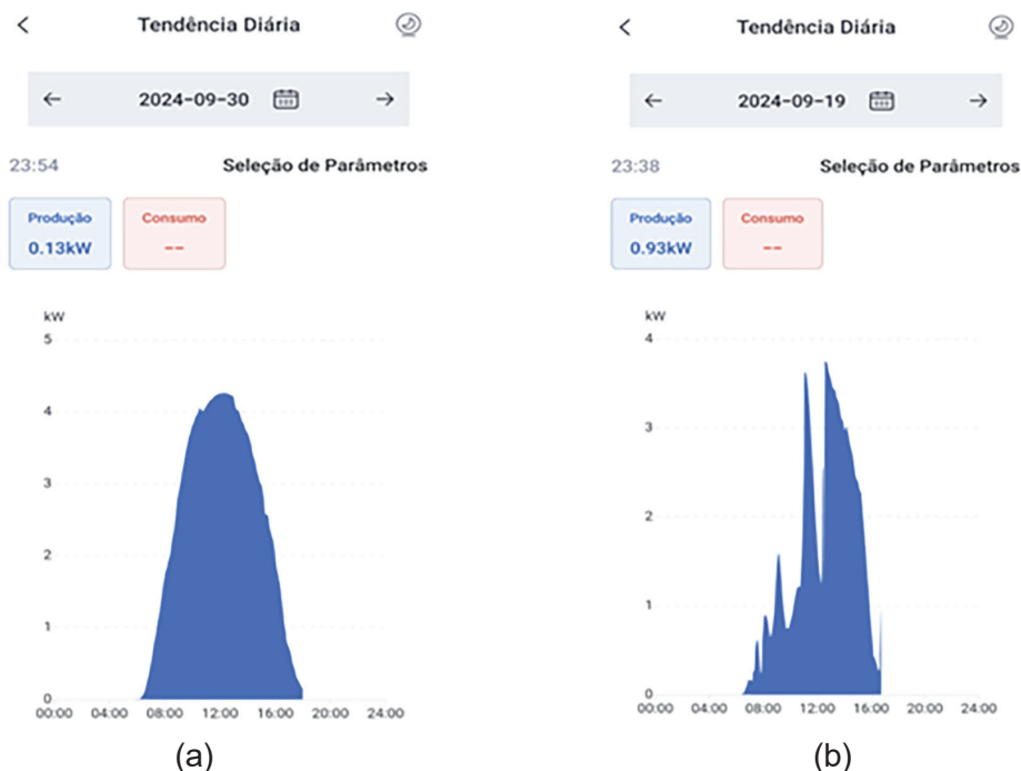
Figura 4.22 - Padrão diário de geração de uma UFV em condições de (a) céu limpo e (b) grande nebulosidade.
